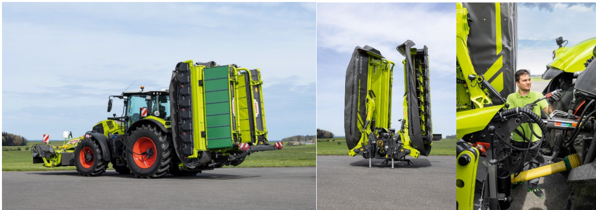
Weitere Argumente des DISCO 9300 C AUTO SWATHER: Kompakt im Transport und beim Abstellen, sicher und komfortabel bei An- und Abbau.
