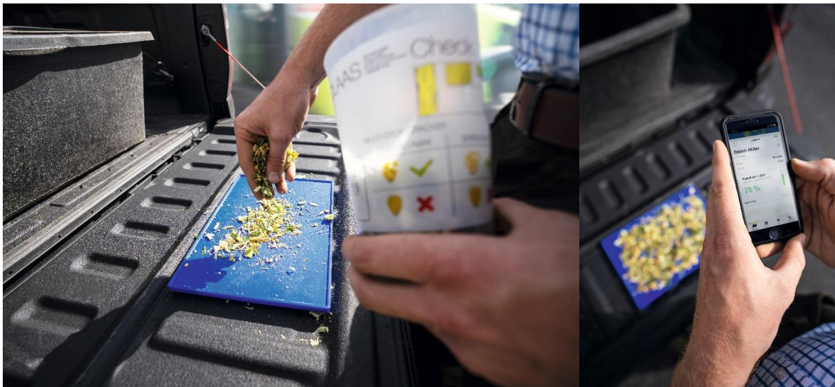
Wofür bisher ein Labor erforderlich war, lässt sich nun unmittelbar während der Ernte im Feld erledigen: Die Ermittlung des Kornaufbereitungsgrads mittels App im neuen CLAAS connect.
