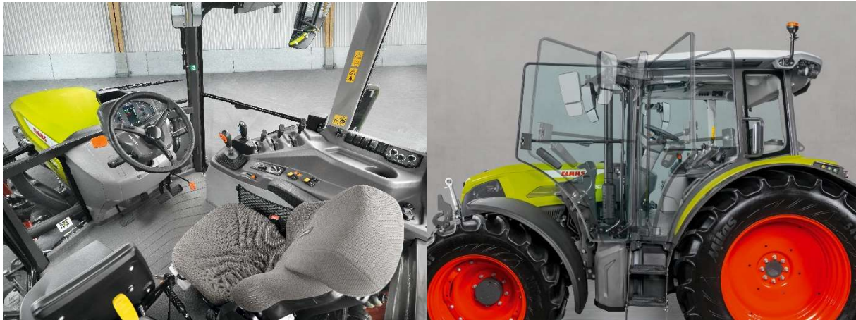
Die Kabine zeichnet durch ein großzügiges Platzangebot, große Glasflächen und eine optimierte Rundumsicht aus. Die nach vorne öffnenden Türen lassen sich in 180-Grad-Position arretieren.
